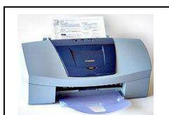
je výstupní zařízení, které slouží k přenosu dat uložených v elektronické podobě na papír nebo jiné médium (fotopapír, kompaktní disk apod.).
