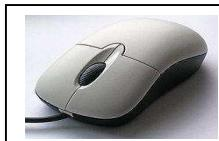
malé polohovací zařízení, které převádí informace o svém pohybu po povrchu plochy (např. desce stolu) do počítače,
